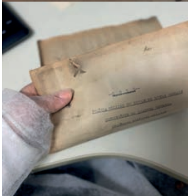
Figura 5 e 6 - Processo em que o grampo de metal oxidou a folha e na retirada houve a ruptura do pedaço de papel
